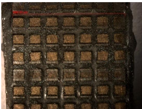
c. Matrice de magneți permanenți pe suport, Microscopie optică, 10x
