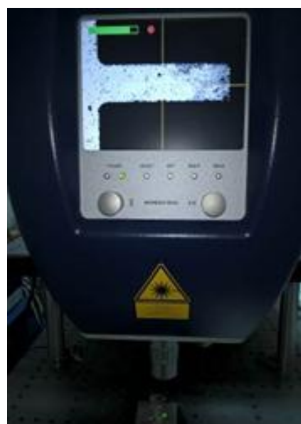
Fig. 16 Poziția elementelor de test (microgrinzi pe placheta) și o microgrindă în timpul testelor vibrometrul MSA-400
